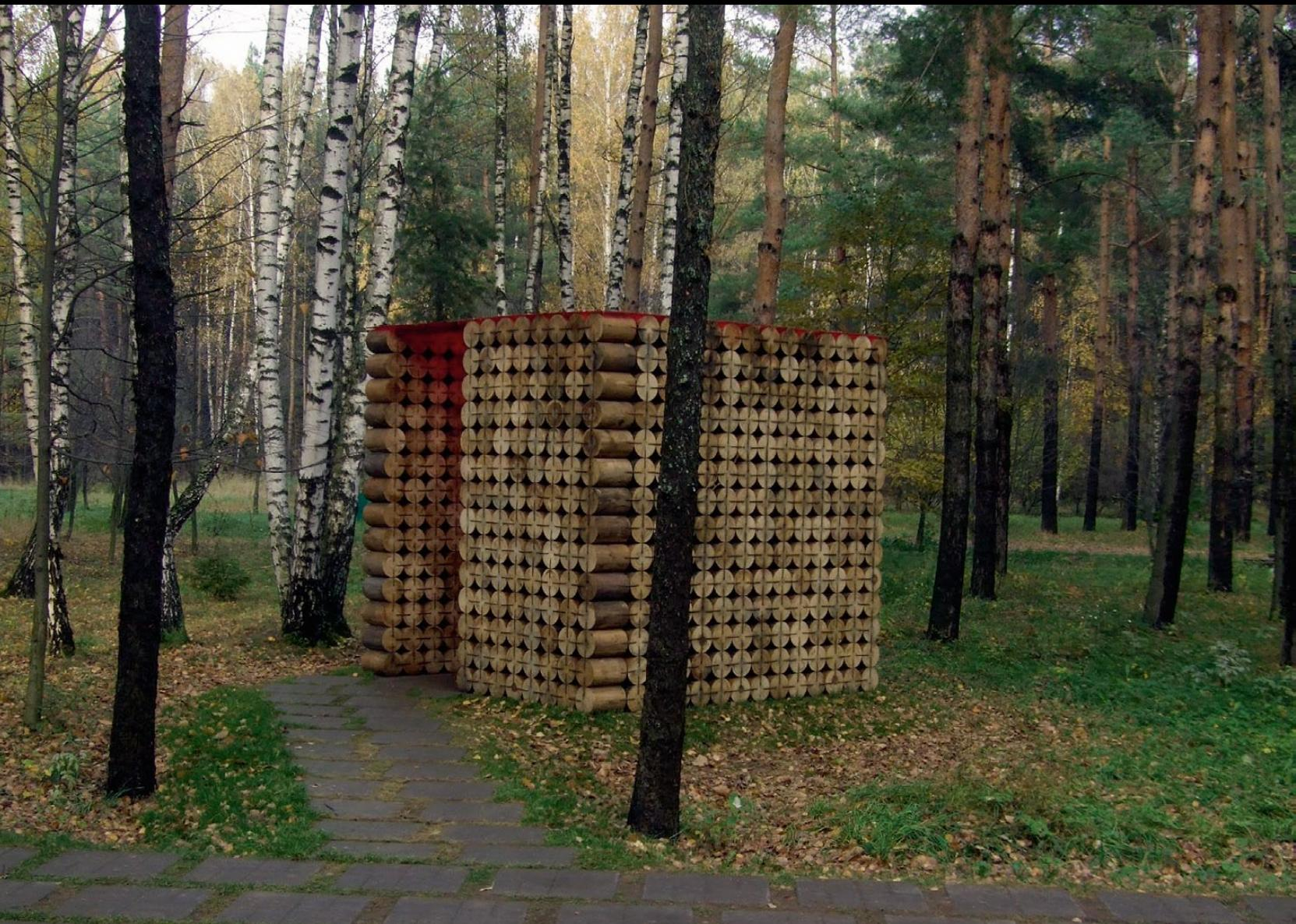
На проектируемом участке разравнивается песок и укладываются тротуарная плитка. Конструкции выполнены из цилиндрованных деревянных брусков, скрепленных между собой стальными скобами.
