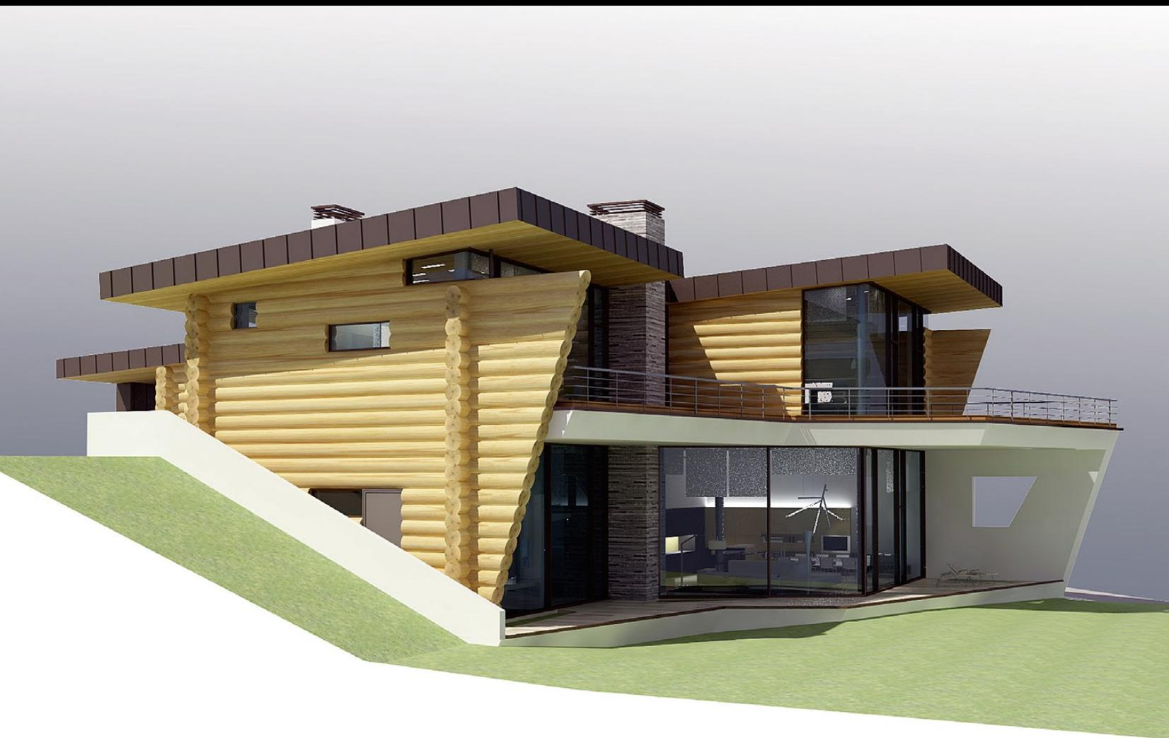
Три жилых корпуса переменной этажности встроены в существующий рельеф таким образом, что при въезде на участок виден лишь один этаж. Одновременно виды из основных помещений и двухсветных пространств ориентированы на береговую линию. Верхние этажи возводятся из кедра, тогда как нижние – бетонные. Несущая конструкция – монолитный железобетонный каркас с заполнением попеременно кедровым бревном, оштукатуренным утеплителем, витражами. Те же материалы использованы и в интерьере.
