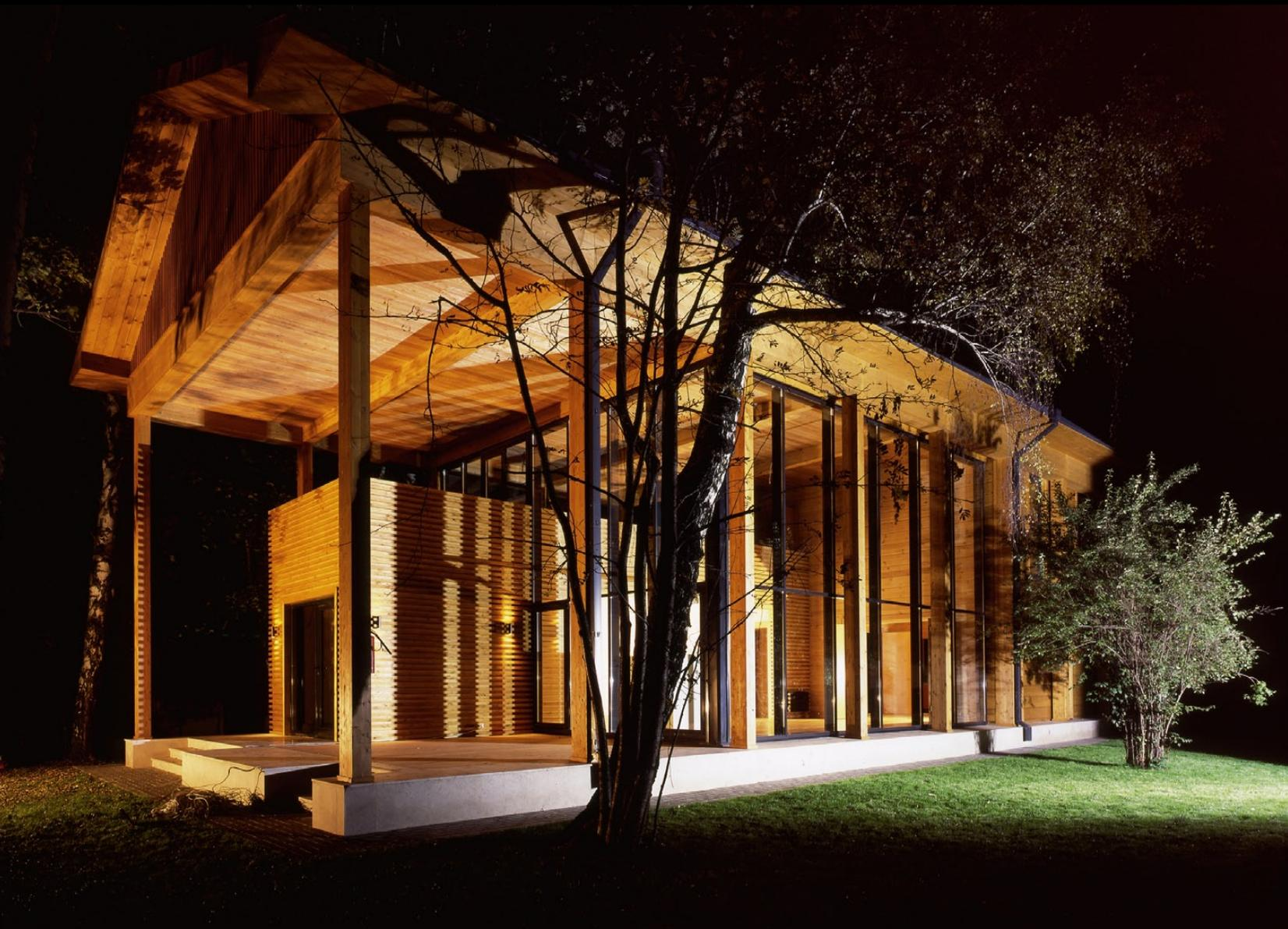
Конструктивная схема дома состоит из двух частей: в двухэтажном срубе из бруса размером 270 x 200 мм находятся жилые комнаты и кухня, по периметру всего дома с шагом 3 м стоят колонны из бруса, автономно несущие кровлю. Это позволяет витражно остеклить двусветную гостиную в западной части дома.
